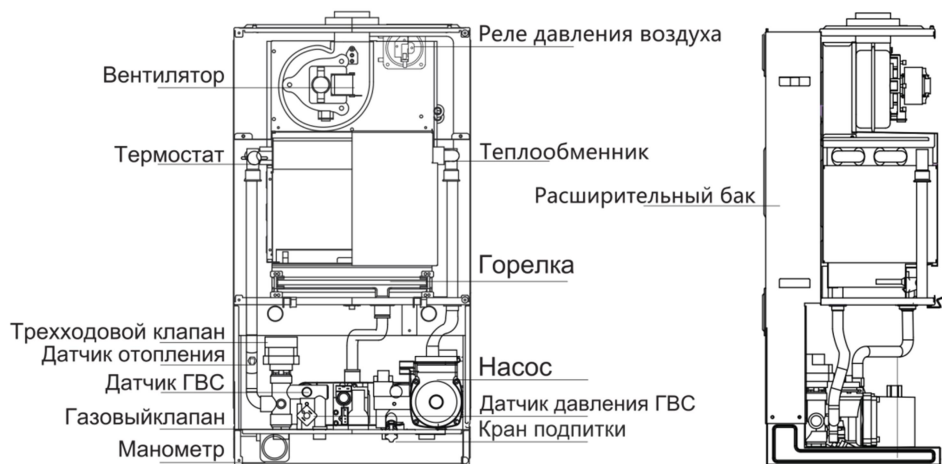
Рисунок 2. Расположение основных узлов котла
